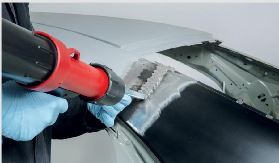
Es una técnica basada en la aplicación de productos que reproducen el sellado original del fabricante en juntas, holguras, cordones o pliegues.
