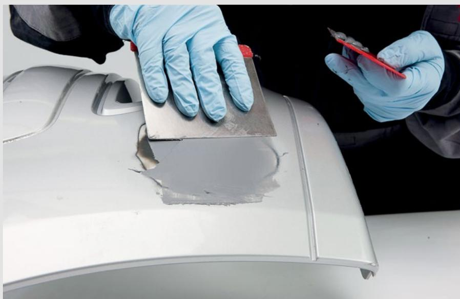
Se utilizan para la reparación de golpes, rayones y anomalías en la carrocería, además del ensamblaje de piezas. Podemos encontrar diferentes tipos de masillas, indicadas para diferentes usos:
