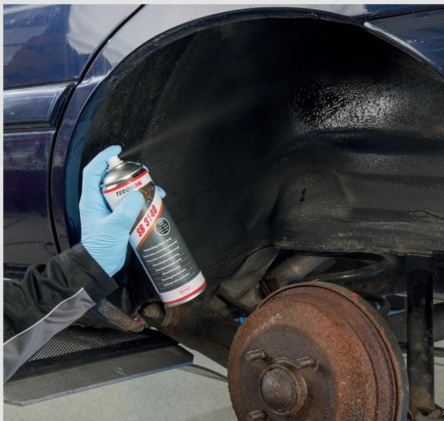
**Son productos imprescindibles para evitar la corrosión en el vehículo después de la reparación o sustitución de alguna parte de la carrocería.**
