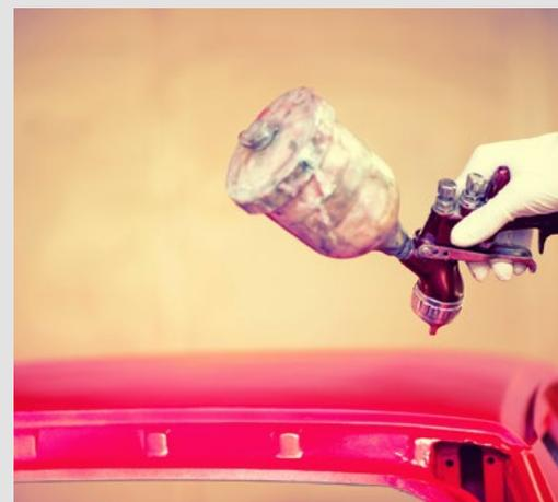
La pintura debe aplicarse de forma uniforme, manteniendo una distancia constante entre la pistola y la pieza a pintar (unos 15 centímetros).
